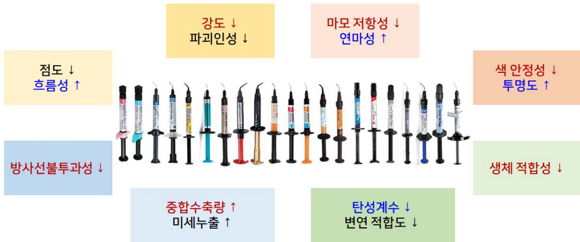
그림 1. Packable resin과 비교하여 filler 함량이 감소함에 따른 flowable resin의 특성
